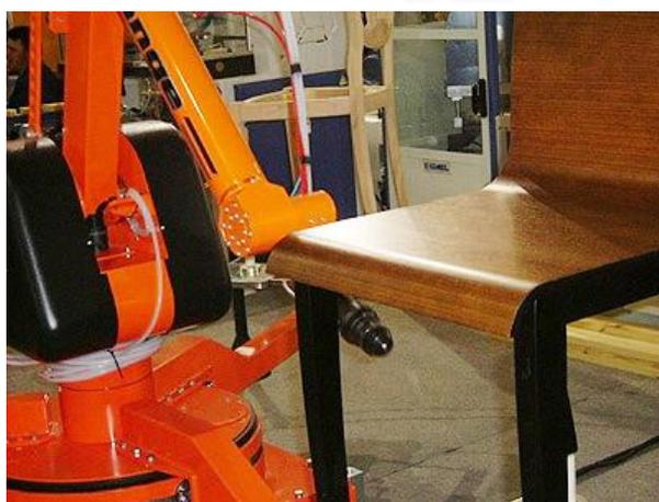
***Il sistema elettrostatico automatico AL4 permette di verniciare particolari metallici, in legno, strutture ed altro con risparmio notevole nei consumi ed aumento della velocità produttiva. Adatto al settore della carpenteria in genere o del legno, può spruzzare materiali vernicianti anche molto densi od abrasivi, con risultati di finitura eccezionali.***
